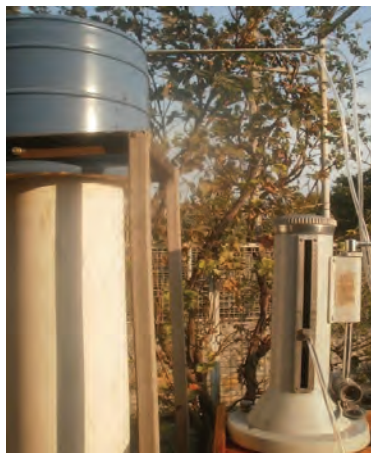
Рисунок 4.3 – Вимірювання характеристик повітряного потоку трубкою Піто-Прандтля з мікрометром МКВ-250
